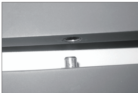
图6 定位销和定位孔 Fig.6 Orientable pin and hole
