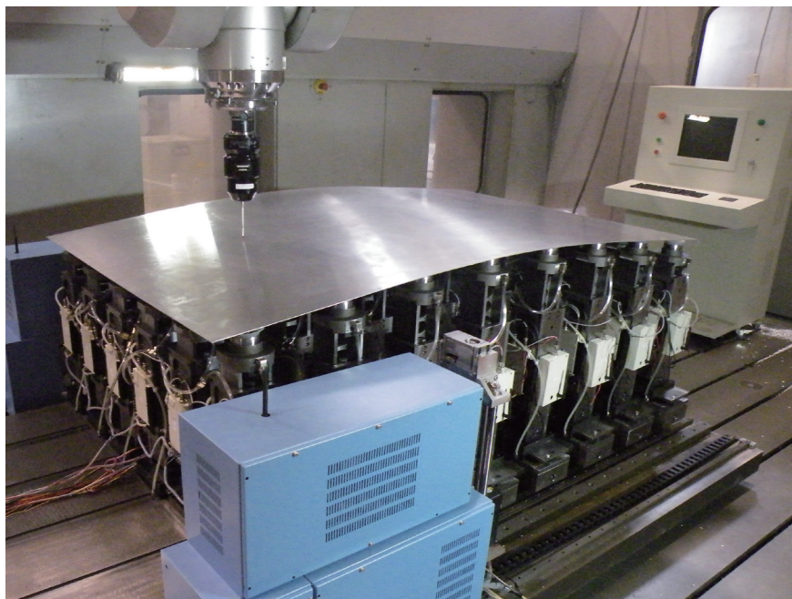
图2 用于大型薄壁件切削加工的智能柔性工装系统
