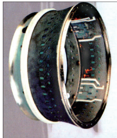
图5 IHPTET第二阶段验证的CMC燃烧室
