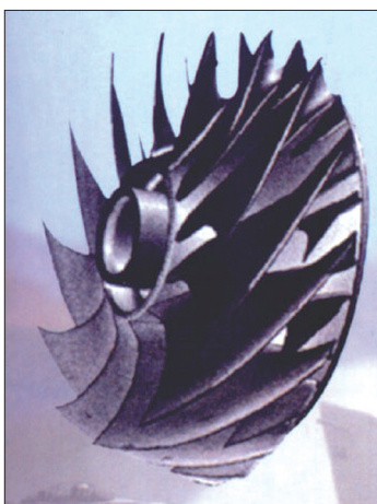
图2 IHPTET计划研制的分流小叶片转子
