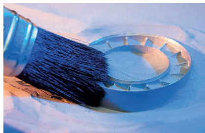
图3 Inconel 718粉末SLM成形试件
