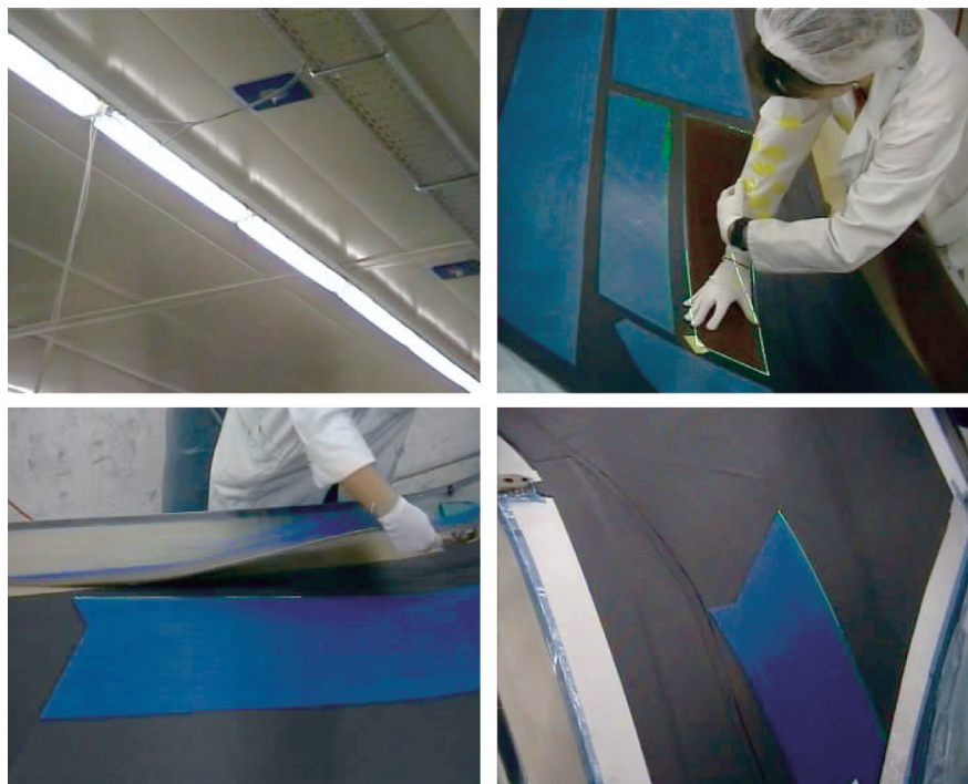
图1 复合材料数字化下料及激光投影铺贴
