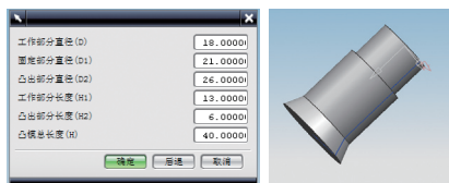
图5 级进模三维零件库的应用
