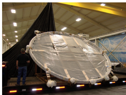
图2 铝锂合金辊锻成形“Y”形连接框
