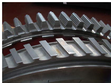
图2 GF航空发动机压缩机圆盘带树型和楔型叶片安装槽
