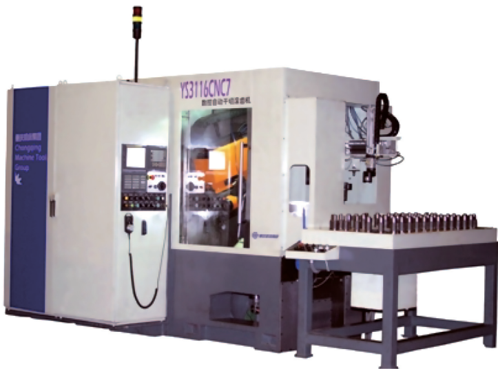
图3 重庆机床集团与重庆大学合作开发的YS3116CNC7高速干切削滚齿机床
