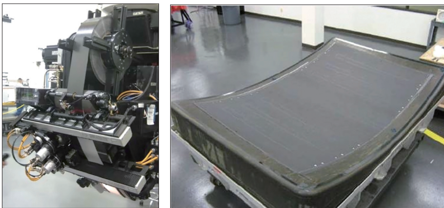
(a) 装在自动铺带机头上的 OoA 预浸料
