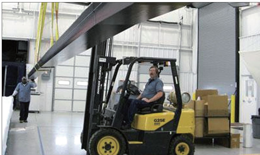
图7 Phantom Eye无人机上采用热压罐外固化预浸料制造的翼梁
