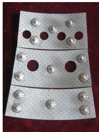
图7 TLP用于连接制造新型发动机燃烧室多孔层板高温部件
