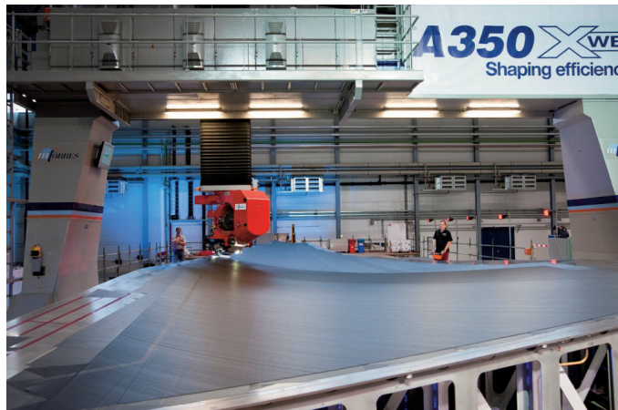
图4 空客A350XWB复合材料机翼蒙皮铺带
