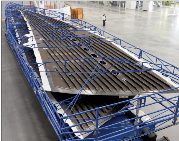
图3 空客 A350XWB 复合材料机翼
