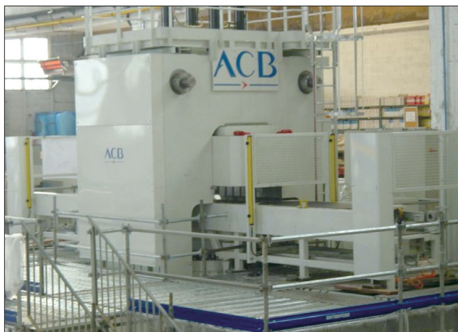
图9 橡皮垫成形机床
