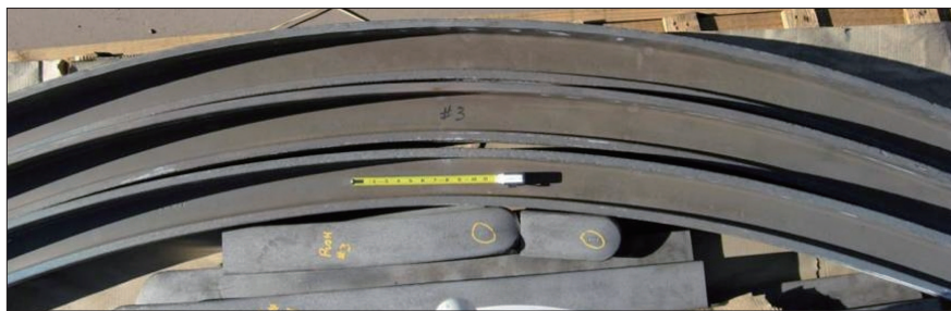
图8 热拉弯成形的零件
