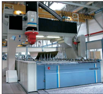
图4 柔性夹持精确切边
