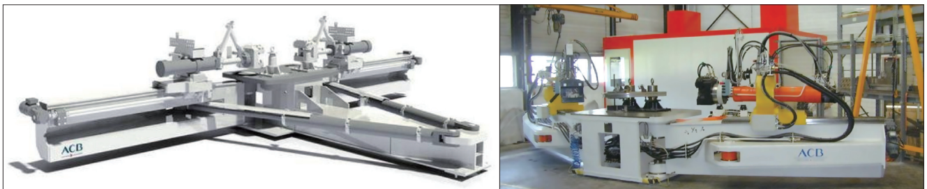
图7 转臂式拉弯机
