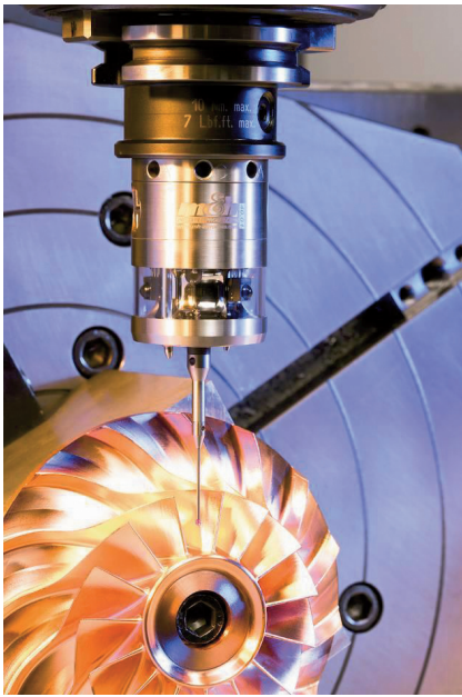
图3 m&amp;h在机检测叶轮过程中
