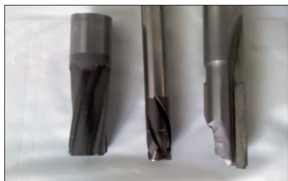
图8 已破损的碳纤维加工专用刀具
