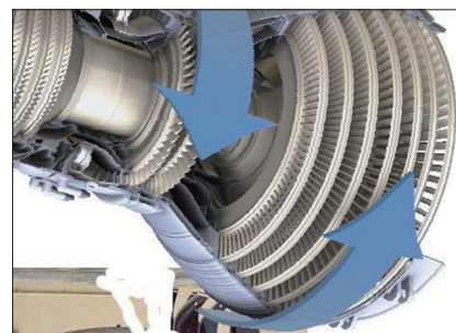
图12 GE公司的GENx发动机剖视图
