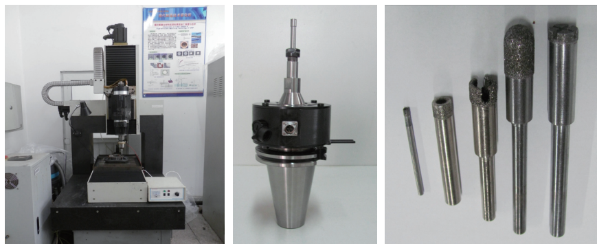
图12 采用旋转工具的超声辅助磨削系统、超声刀柄和加工工具
