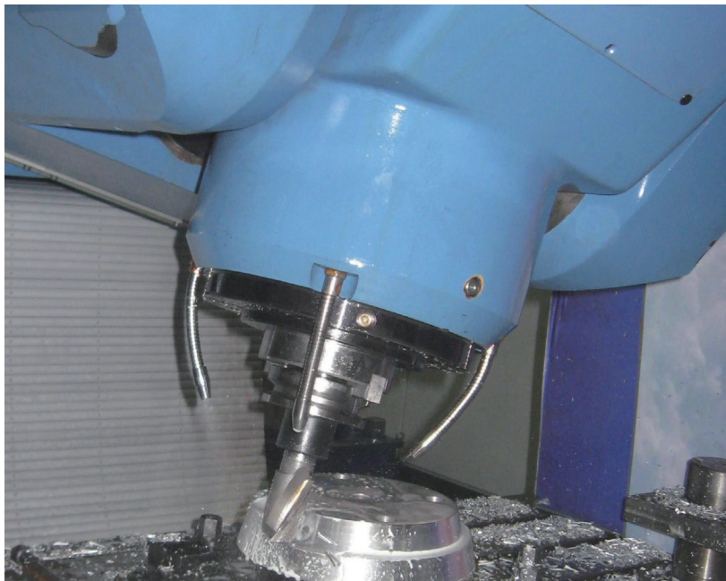
图1 北京航空制造工程研究所A/B摆角立式加工中心的五轴试切
