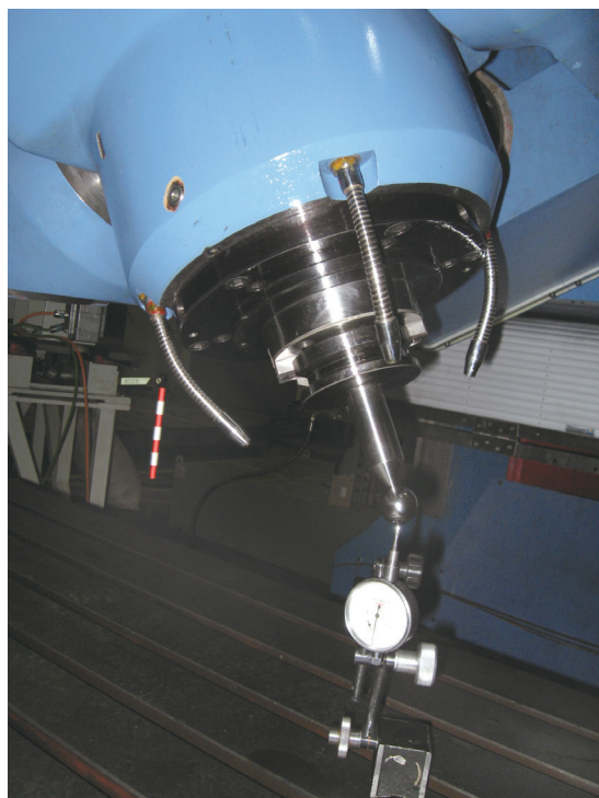
图2 RTCP运动精度的检测
