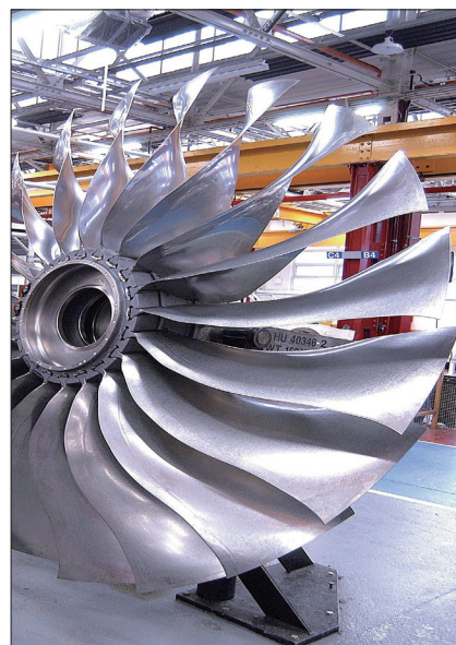
图4 采用SPF+DW方法制造的Trent1000钛合金宽弦空心风扇叶片
