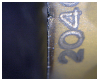
(e) 切削液冷却,切削 48min
