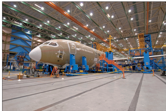
图5 波音787部件对接
