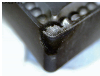
(a) 在钛合金加工中主要的磨损是月牙洼磨损和崩刃
