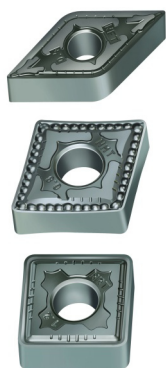
图5 为加工钛合金和抗月牙洼磨损而研发的瓦尔特 Sky·tec™ 家族的ISO可转位刀片
