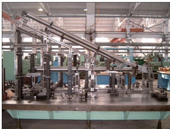
图6 数字化拼装的大型柔性组合夹具
