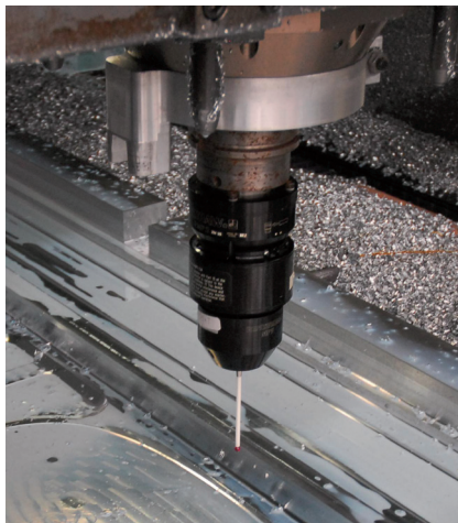
图3 在线测量加工结果用于精加工工艺准备
