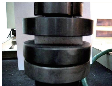
图8 X-cor泡沫夹层平面压缩性能检测装置
