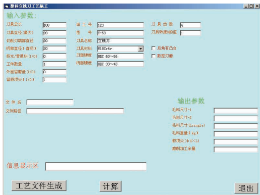
图4 CAPP参数输入、输出及工艺文件生成界面
