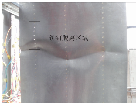
图 1 钣金长桁壁板压缩试验破坏形式
