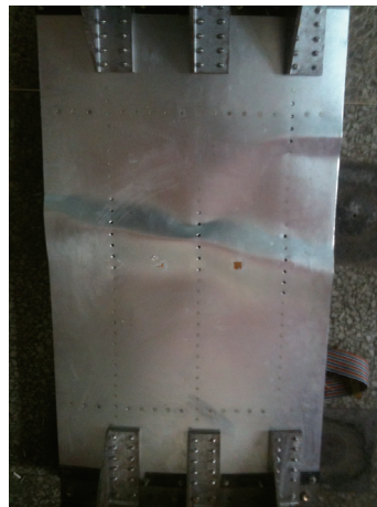
图 2 挤压长桁壁板压缩试验破坏形式
