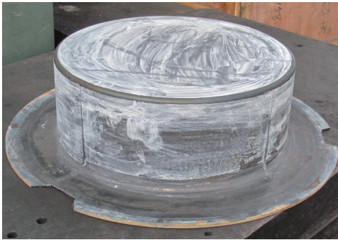
图5 Ti750超塑成形筒形件
