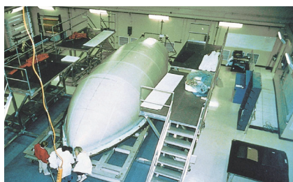
图10 铺层结束,进罐前的Delta II 的有效载荷整流罩
