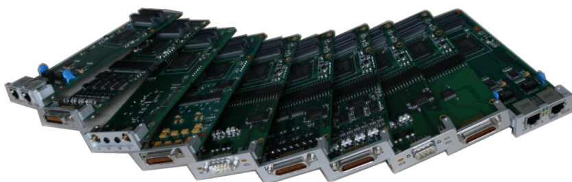
MARS提供了丰富的电气信号接口(如CAN、1553B、AFDX等)
