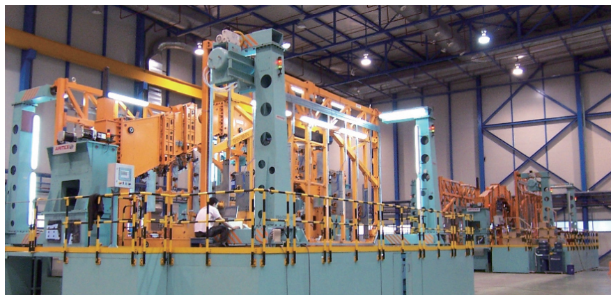
图1 F5/ EFA机翼骨架和壁板蒙皮柔性定位系统
