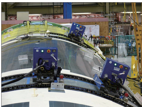
图1 柔性轨道自动制孔系统
