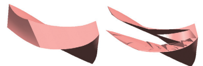
图7 风扇盘通道的盘铣开槽
