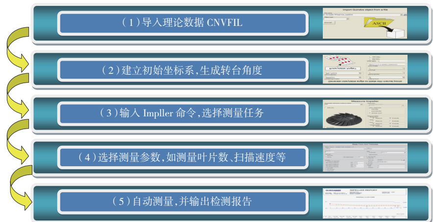
图6 QUINDOS 7 叶轮测量步骤
