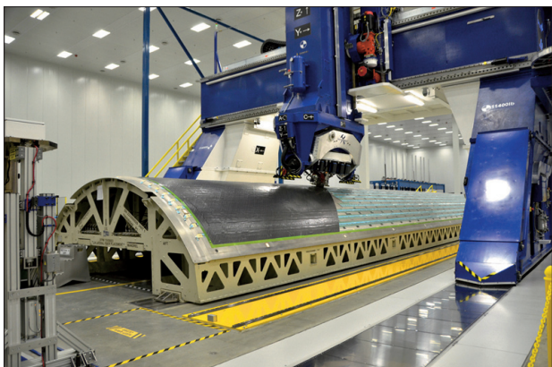
图4 中机身复合材料壁板的铺放情况
