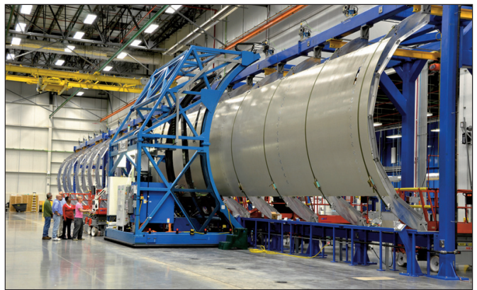
图6 中机身壁板铆接装配情况
