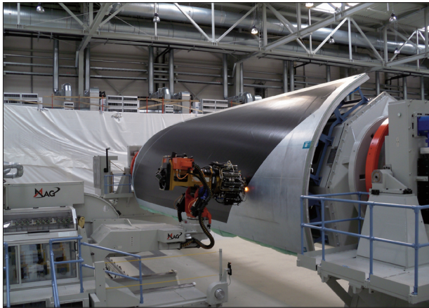
图3 机身16~18段壁板的铺放情况
