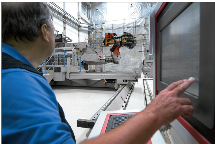
图2 技术人员操作自动铺丝机的情况
