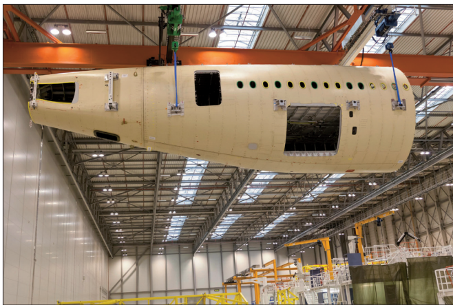
图10 装配完成的A350XWB的后机身段
