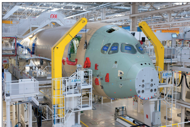
图11 A350XWB的机身前段和中段总装对接
