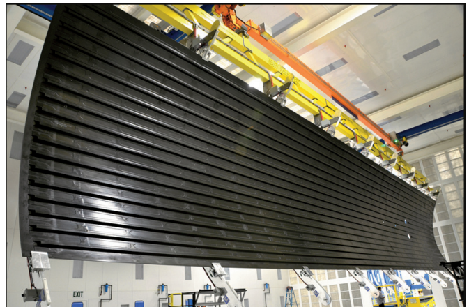
图5 制造好的中机身壁板
