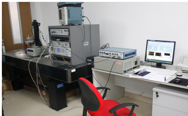
图3 BLUT激光超声检测系统硬件平台
