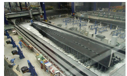
图3 波音787机翼蒙皮水切割激光雷达在机测量
