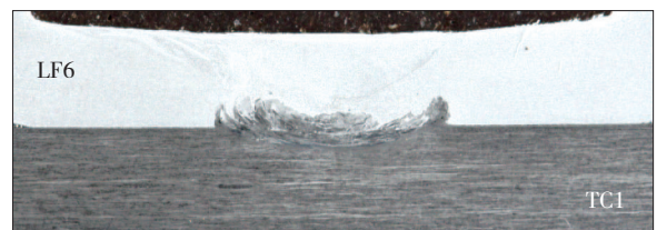
图6 Al/Ti异种金属搅拌摩擦焊搭接接头横截面形貌
