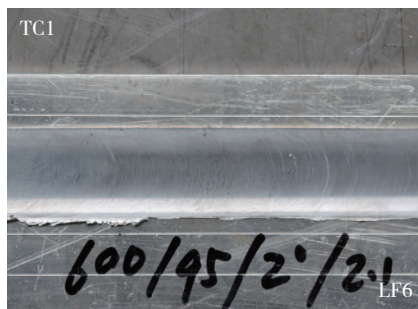
图5 Al/Ti异种金属搅拌摩擦焊搭接接头表面形貌
