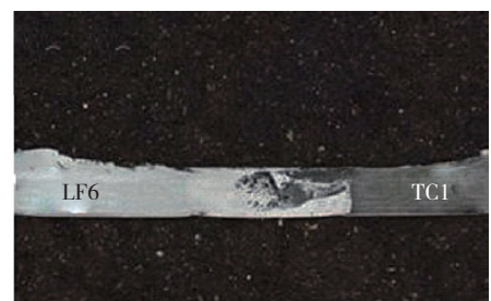
(b) 焊接接头横截面形貌
