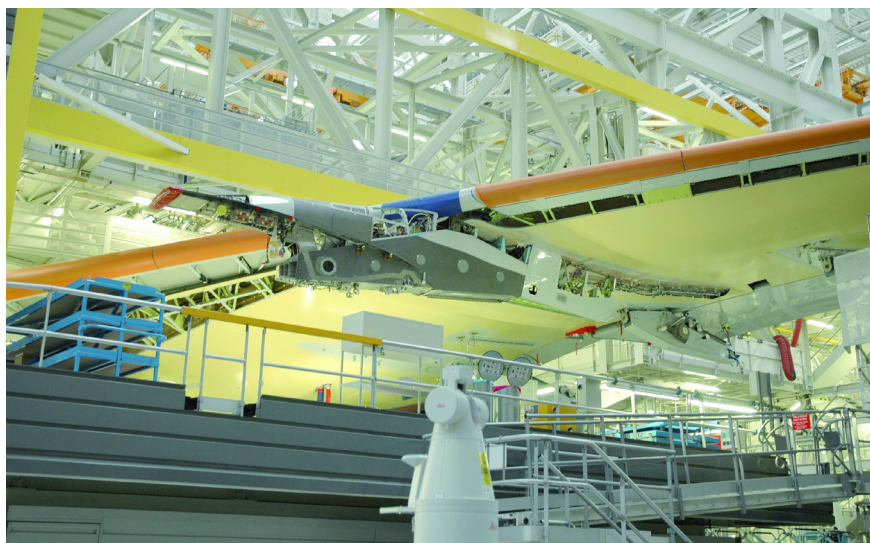
图4 空客A380采用4台Leica激光跟踪仪完成数字化装配
