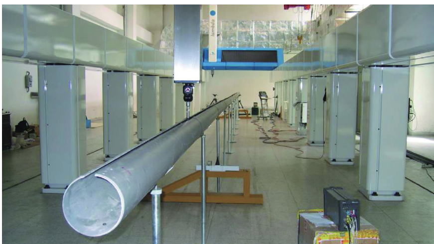
图3 龙门式三坐标测量机用于西飞大型零部件质量验证
