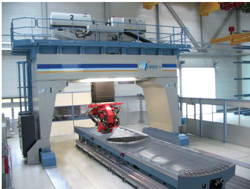
图2 诺登哈姆车间的激光焊接生产线 [4]
