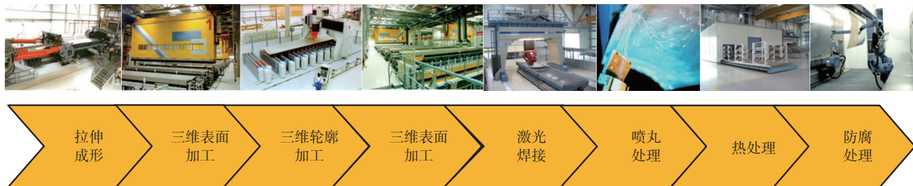
图3 双光束激光焊接工艺流程 [4]
