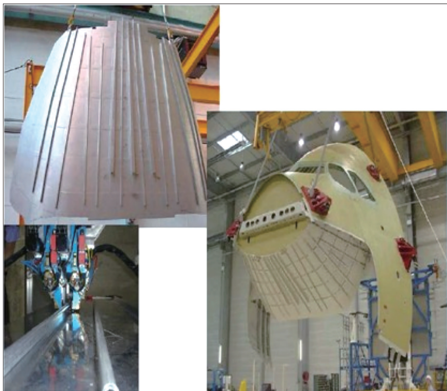
图4 采用双光束激光焊接的A380机头下壁板
