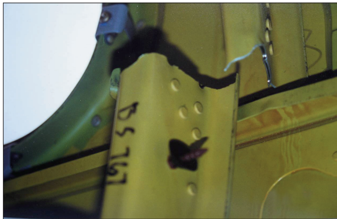
图3 压力隔框结构断裂
