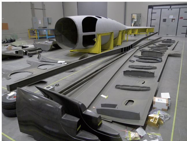
图2 整体制造成型的领航150复合材料机身
