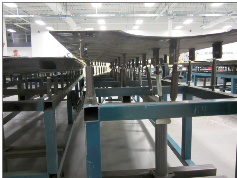
图4 工装柔性连接形式
