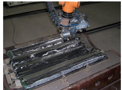
图8 Tufting缝合曲面加筋壁板
