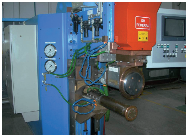
图3 中航工业空空导弹研究院引进的SM-AS-2/200/1000型直流纵横两用滚焊机
