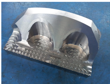
图6 下限动块零件 Fig. 6 Lower blocker
