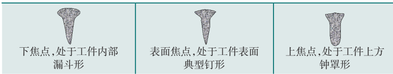
图2 焊缝截面的形貌
