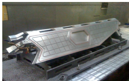
图6 零件外形数控加工工装
