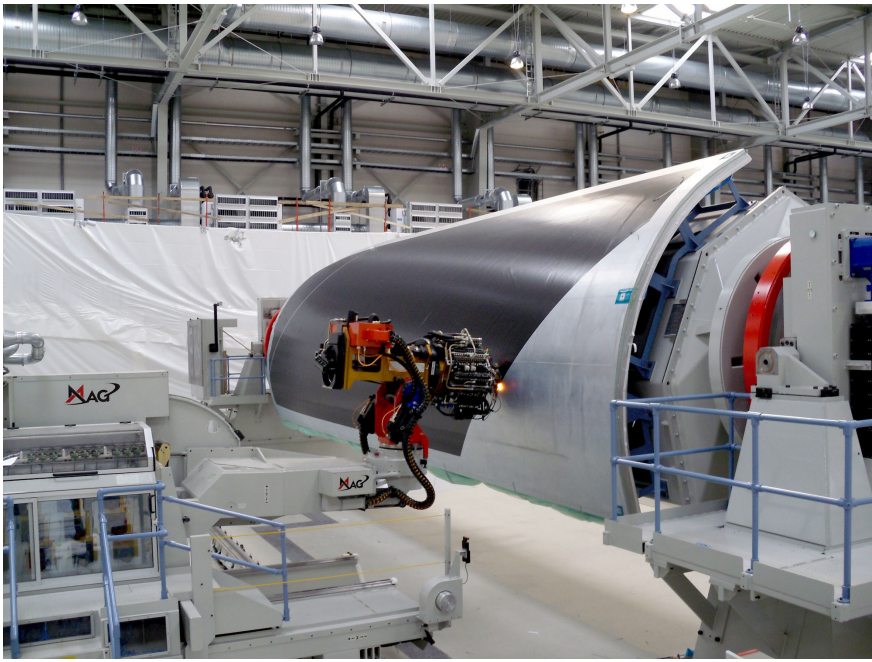
图5 用MAG铺带机Aerotec前机身12段板件
