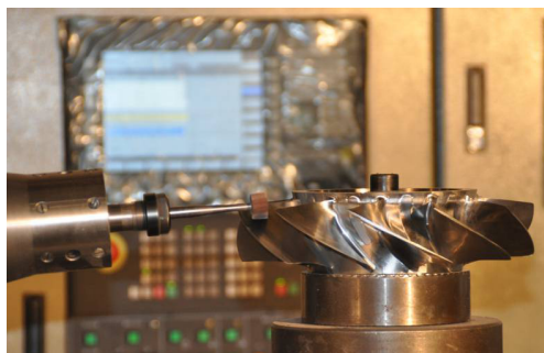
图2 五坐标机械手抛光机抛光叶盘零件
