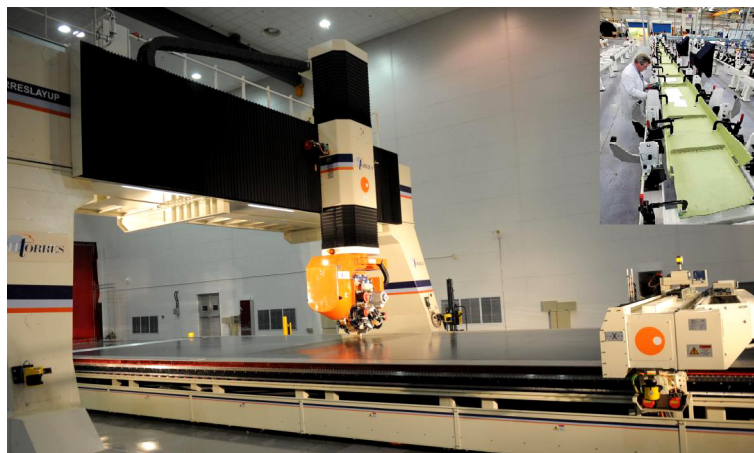
图7 平面铺带辅助热成型工艺制造A400M机翼大梁
